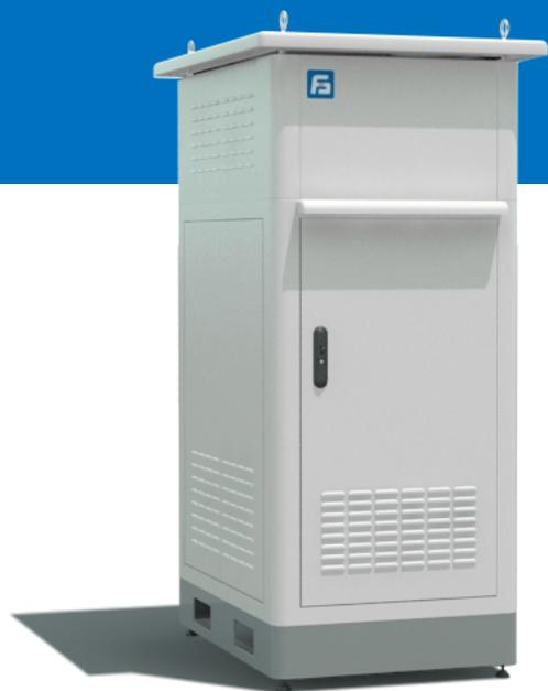
弗尔赛能源有限公司研发并生产的通信用氢燃料电池备用电源产品，是以氢燃料电池为核心的新一代绿色能源供电系统。在主供电网络不稳定或故障的情况下，燃料电池备用电源自动启动，将储存的燃料（氢气）与空气进行电化学反应，产生电能给通信设备供电。产品具有安全性高，可靠性好，超静音，技术先进等优点，可广泛应用于电信机房，通信基站，网络数据中心等领域，为用户提供真正零排放的后备不间断电源。
