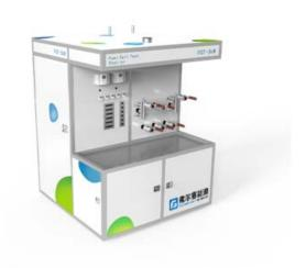
燃料电池电堆测试平台主要由控制单元、单电池电压巡检单元、 冷却单元、空气供应单元以及 DC/DC 单元组成。
